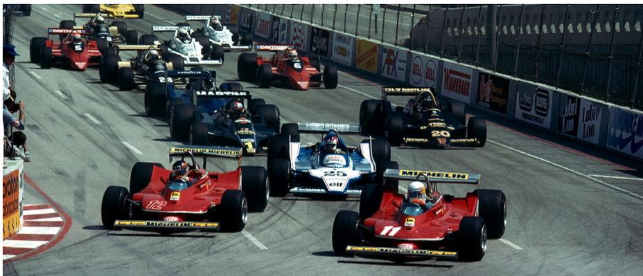
Dopo la vittoria dell'anno precedente di una imprendibile Lotus, tutte gli ingegneri delle varie scuderie si sono dati molto da fare, nel 1979, per estremizzare al massimo il principio dell'effetto suolo con bandelle laterali mobili, dette: "**minigonne**".
